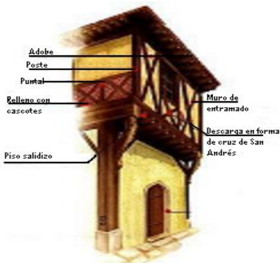
Casa con muros de entramado y salidizos
